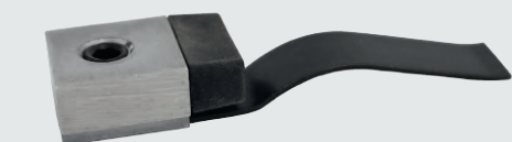
Feststellung inklusiv Öffnungsbegrenzer für Gleitschiene B - Zubehörset FKL-E einstellbare Federrastklemmung für Gleitschiene „B“, inklusive Öffnungsbegrenzer Nicht für den Einsatz im Brandschutz zugelassen. Zur Offenhaltung von Türen mit Gleitschienen-schliessern EN2-EN5, Haltekraft stufenlos einstellbar
