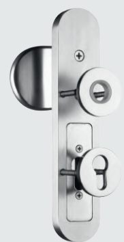
Goli X-Z Alu silber, EV 1 Sicherheitskombigrt. zur Gegenverschraubung von Rosettengarnituren; Außenschild mit Zylinderabdeckung für 15 mm Überstand
