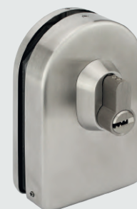
Glastürschloss „socket“ inkl. 5 Schlüssel/ Schließgehäuse aus Kunststoff, und Edelstahl - Schließ- blech - für Glas 8/10 mm, Oberfläche 60 (Edelstahl matt)
